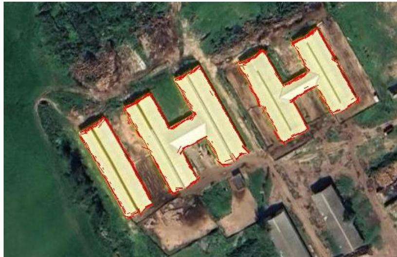
Рис. 2.1.15. Найденные алгоритмом Хюккеля контуры в обрабатываемых областях
