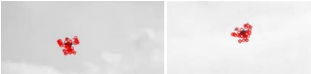
Рис. 2.2.2. Пример обнаружения особых точек на изображении детектором SIFT
