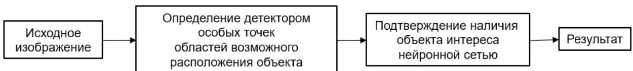
Рис. 3.3.1 – Схема работы предложенного гибридного алгоритма
