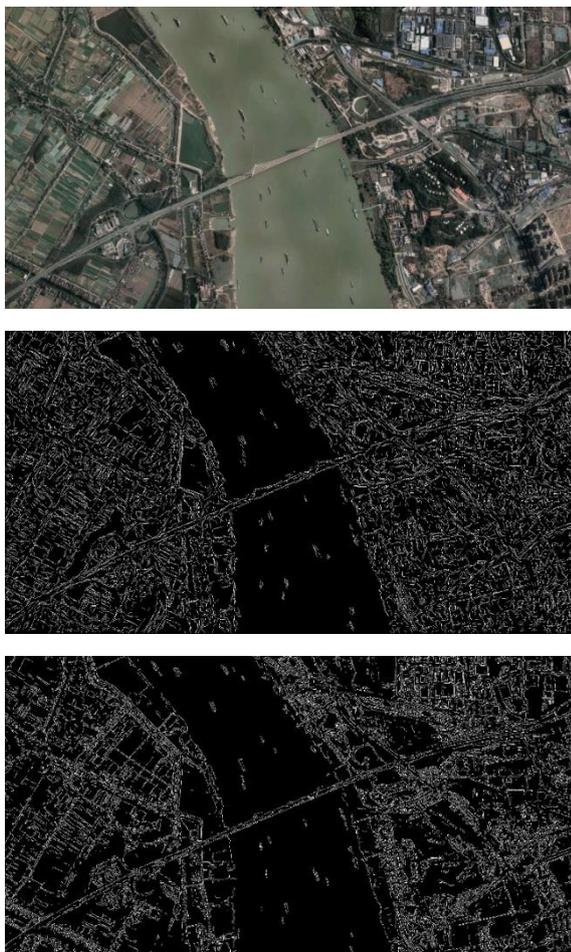
Рис. 3.1.2 Результаты обработки исходного изображения с объектом интереса типа «мост» (сверху) алгоритмами поиска контуров Хюккеля (по центру) и Хафа (снизу)
