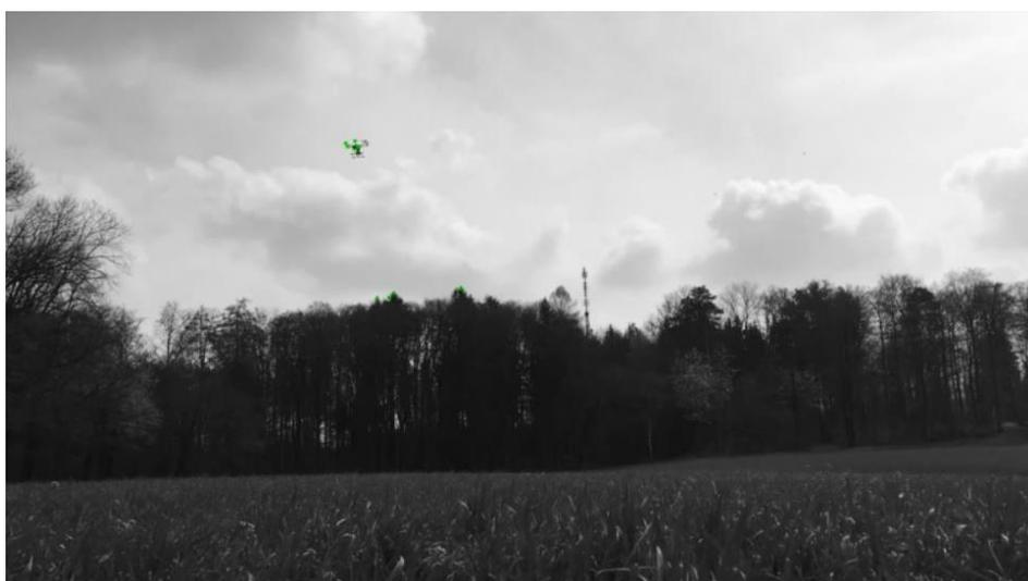
Рис. 3.2.4 – Пример работы детектора особых точек ORB на изображении, содержащем объект интереса
