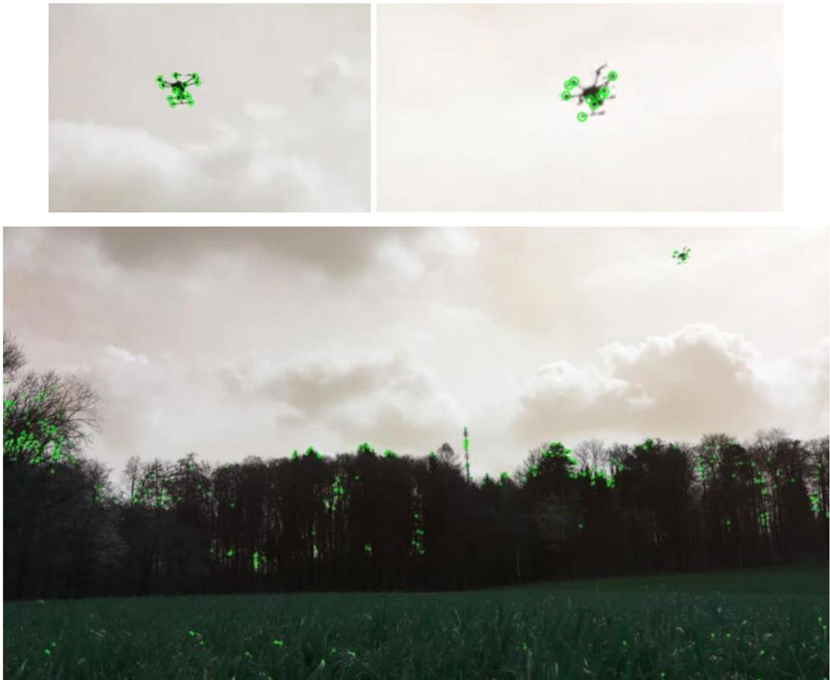
Рис. 2.2.1 Пример применения детектора особых точек FAST
