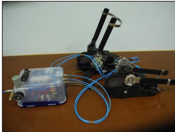
*Рис. 1.* Тренажер голеностопа, стимуляторы, блок управления
