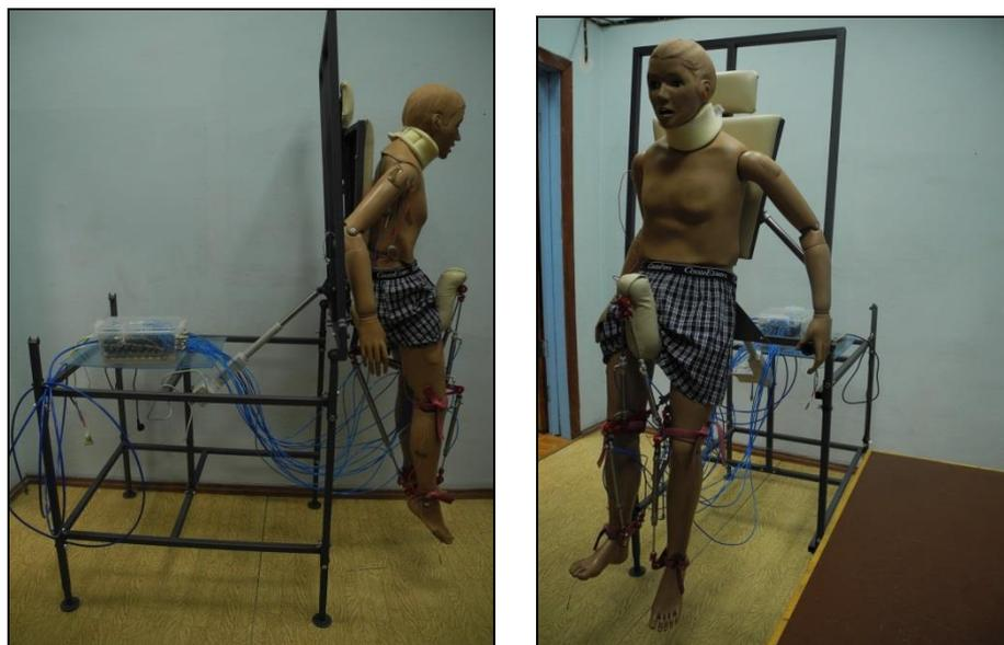
*Рис. 3.* Тренажер-вертикализатор и легопулятор-экзоскелет
