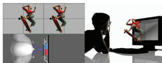
Рис. 5. Отрицательный параллакс; объект воспринимается как находящийся перед плоскостью экрана
