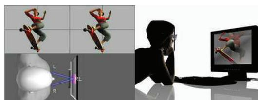
Рис. 4. Нулевой параллакс; объект воспринимается на расстоянии равном плоскости экрана
