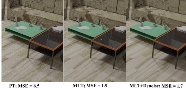
Рис. 7. Сравнение на сцене “comp1” (рис. 14). Время рендера — 10 минут на GTX680.
