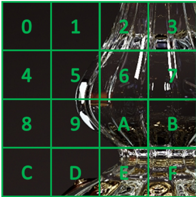
Рис. 1.: Пример изображения, разделённого на 16 тайлов. Каждый тайл пронумерован от 0 до F. Мы сортировали тайлы, основываясь на их максимальной глубине. Тайлы E и F имеют наибольшую глубину. Они приходят в массив потоков первыми. В противовес им тайлы 0,1,4,8,C имеют нулевую глубину и они приходят в массив потоков последними. Таким образом, мы уменьшаем суммарное число вызовов ядер.
