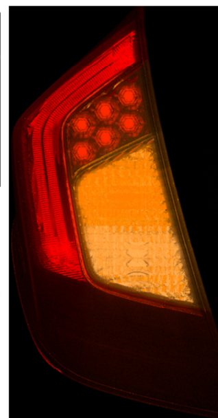
Рис. 5. Расчет яркости: а) световода с объемным рассеиванием, б) заднего фонаря автомобиля
