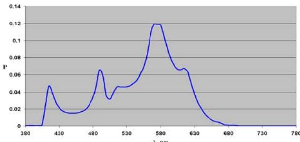
Рисунок 1: Спектограмма источника света для RGB = (6000, 5000, 1000)лм.
