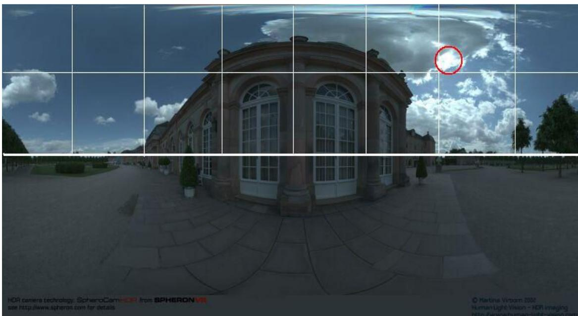
Рис.2. Разбиение карты освещения для автоматического выделения источника света. Красным кружком показан найденный источник света.
