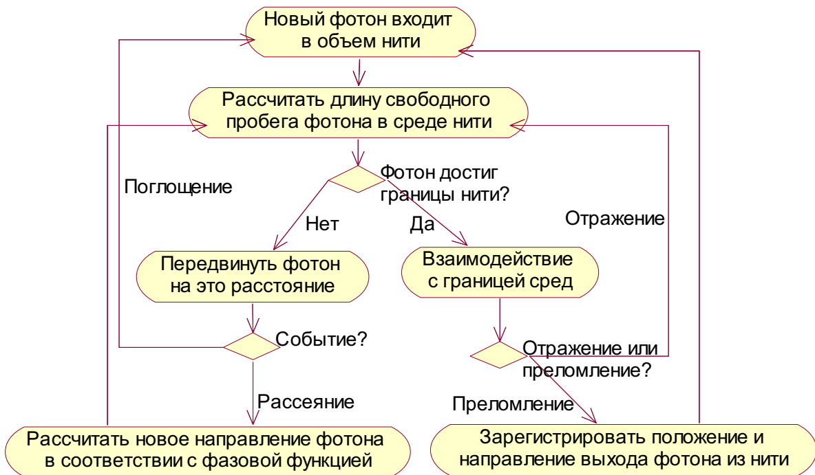
Рис. 4 Алгоритм Монте-Карло трассировки лучей в объеме нити
