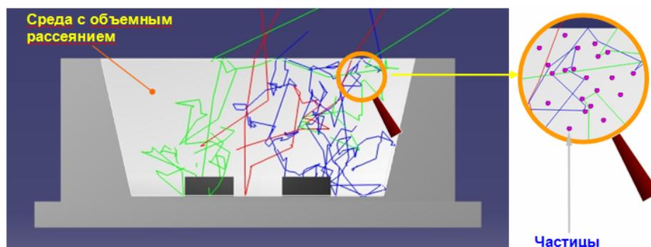
Рис. 14. Визуализация траекторий лучей в кластере светодиодов, помещенных в среду с объемным рассеянием
