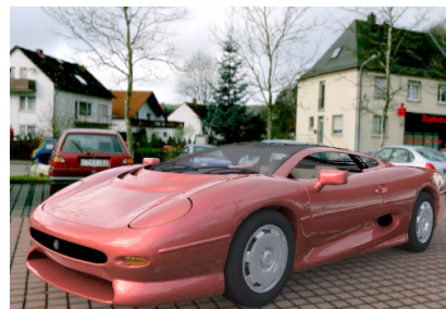
рис.2. Использование изображения с большим динамическим диапазоном яркостей в качестве источника освещения для компьютерной модели автомобиля
