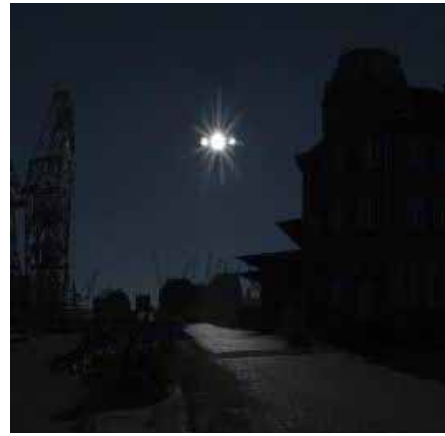
Рис. 8. Дефекты изображения солнца: изображения паразитных “солнц” на БДДИ.
