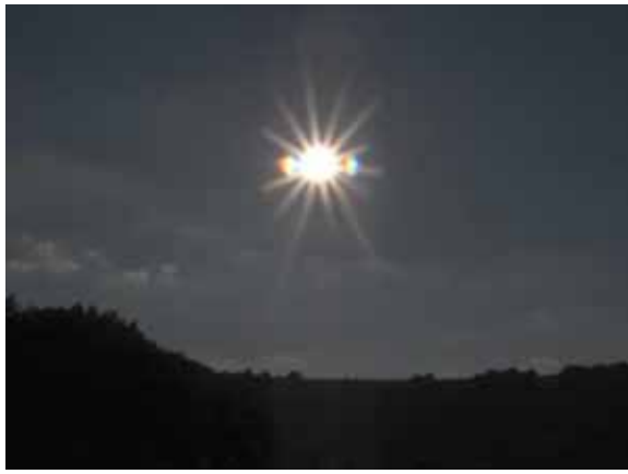
Рис. 8. Дефекты изображения солнца: изображения паразитных “солнц” на БДДИ.
