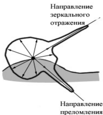
Рис. 4. График типичной функции рассеяния света (сечение).
