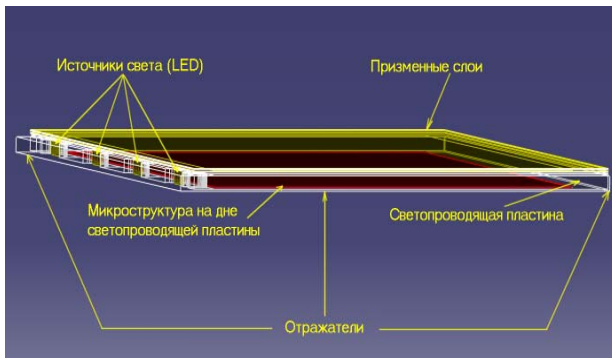
Рис. 6. Осветительная система жидкокристаллического дисплея
