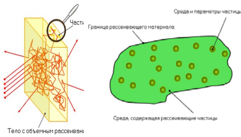
Рис. 9. Тело с объемным рассеиванием
