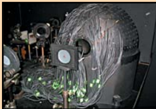
Гониоспектрофотометр, ИПМ, 2000 г.
