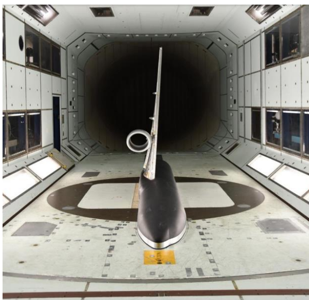
а. 10%-ая модель CRM-HL в 5-метровой низкоскоростной аэродинамической трубе QinetiQ
