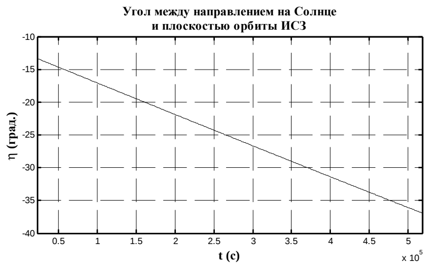
Рис. 1.14 Углы ориентации ИСЗ относительно Солнца и микроускорения (режим полупассивной гравитационной ориентации).
