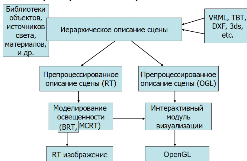
Рис. 8. Архитектура системы генерации реалистичных изображений в реальном времени.
