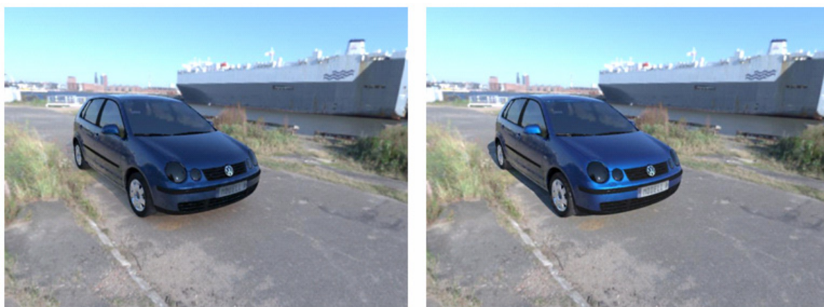
Рис. 4. Применение компенсации некорректности задания солнца. Левое изображение построено без компенсации, правое – с компенсацией. Видны соответствующие солнечному дню четкие тени, которые появились в результате включения режима компенсации.
