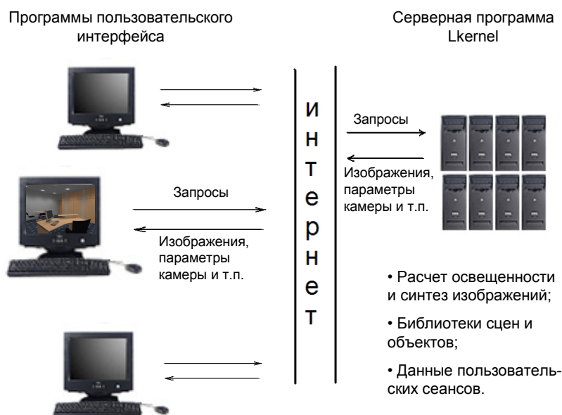
Рис. 6. Организация Интернет-приложения для интерактивного физически аккуратного моделирования освещенности; взаимодействие компонентов пользовательского интерфейса с серверным компонентом.
