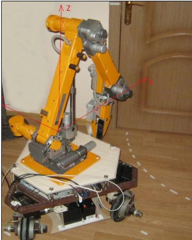
Рис. 1. Подвижная система ПРМ-1 в виде манипулятора, установленного на платформе мобильного робота “ТРИКОЛ” – пример робототехнической системы с 6 степенями свободы схвата и с 14 кинематическими степенями подвижности (СП) механической системы (6 степеней подвижности робота Трикол, 5 – у манипулятора и 3 – у двух камер)
