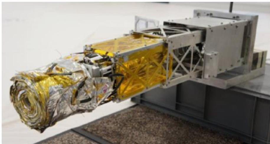
Рис. 6. Телескопический механизм развертывания паруса [6]
