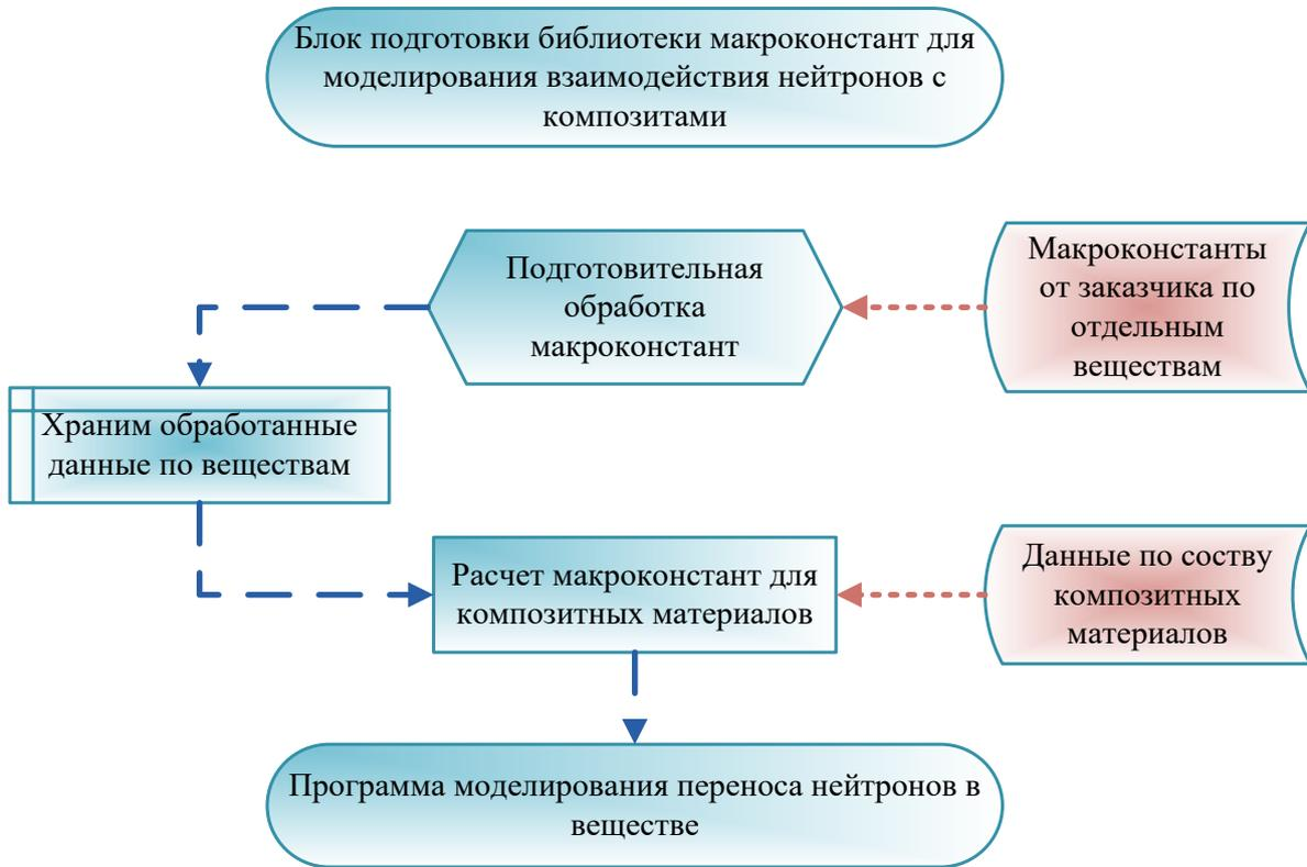
Рис. 2 Блок-схема модуля подготовки библиотеки макроконстант для композитных материалов
