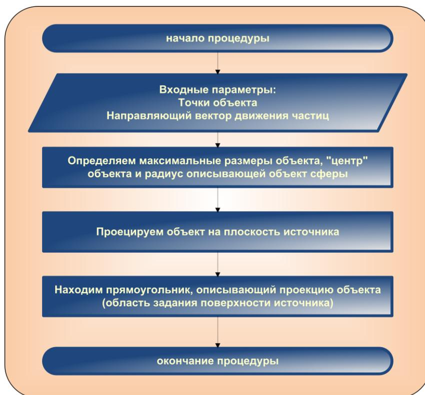
Рис.8 Блок - схема алгоритма моделирования плоского источника
