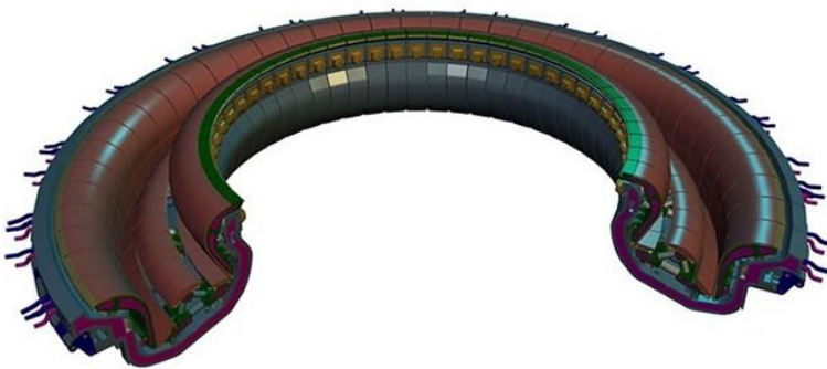
Рис. 1.1. Общий вид дивертора ITER
