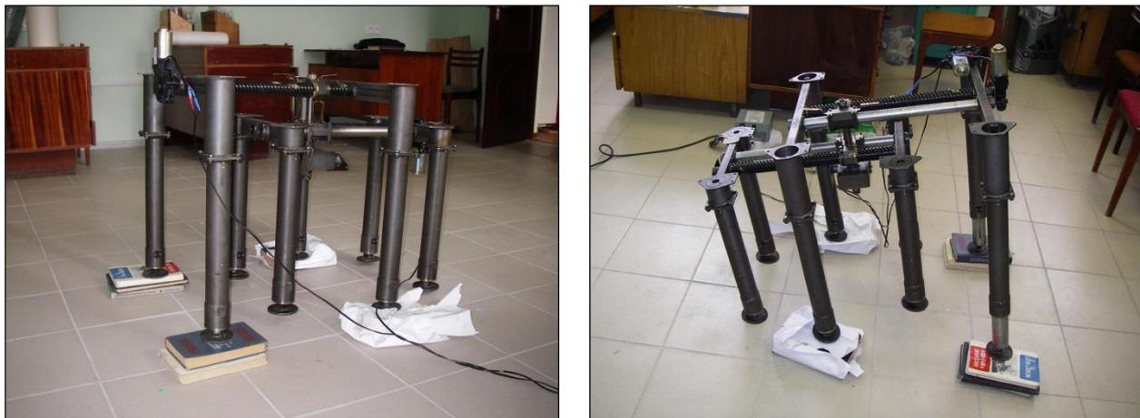
Рис.50. Робот с ортогонально-поворотным двигателем. ВолгГТУ. Волгоград.
