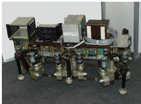
Рис.14. Шагающий робот ИПМ им.М.В.Келдыша РАН.
