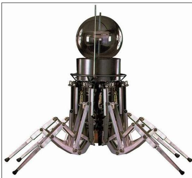
Рис.21. ODEX24. Odetics. США. Первый коммерческий шагающий робот.
