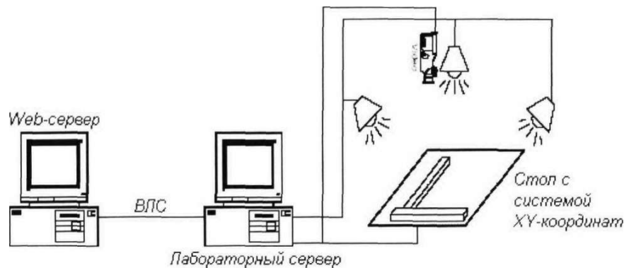
Рис. 1.3. Структурная схема лабораторной установки дистанционного лабораторного практикума, реализованного в системе PEARL
