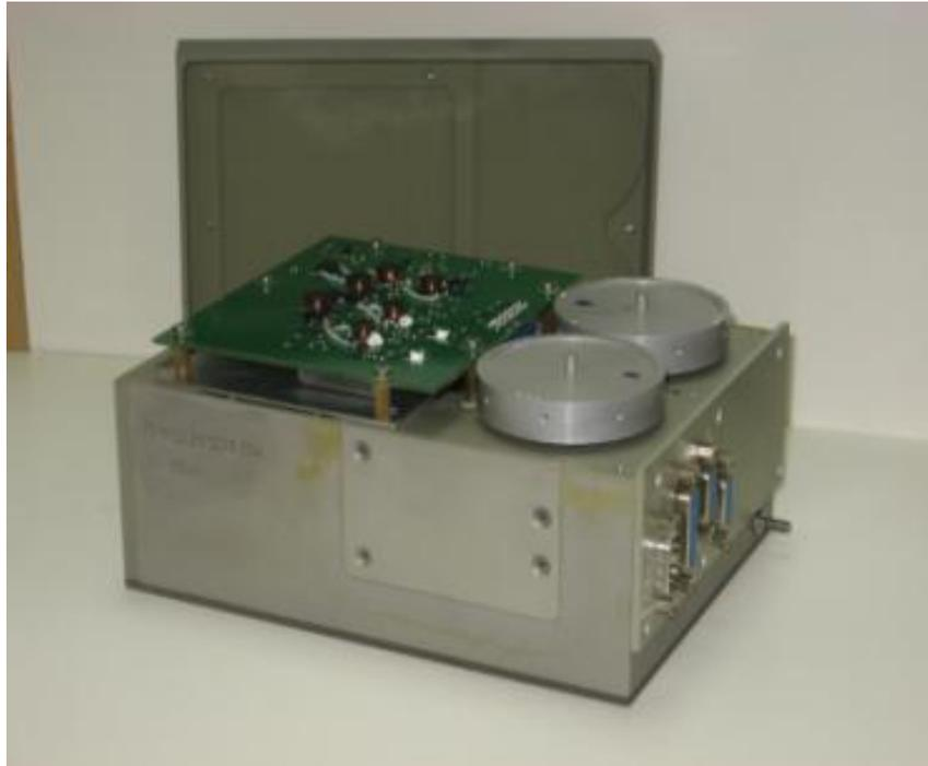
Рис. 1.3. Внешний вид блока управления системой ориентации
