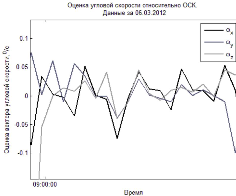
Рис. 5.4. Увеличенный график оценки угловой скорости относительно ОСК во время стабилизации аппарата
