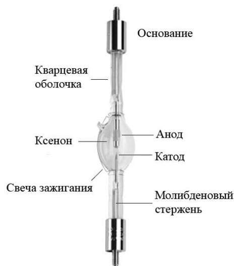
Рис. 3.5. Строение ксеноновой лампы
