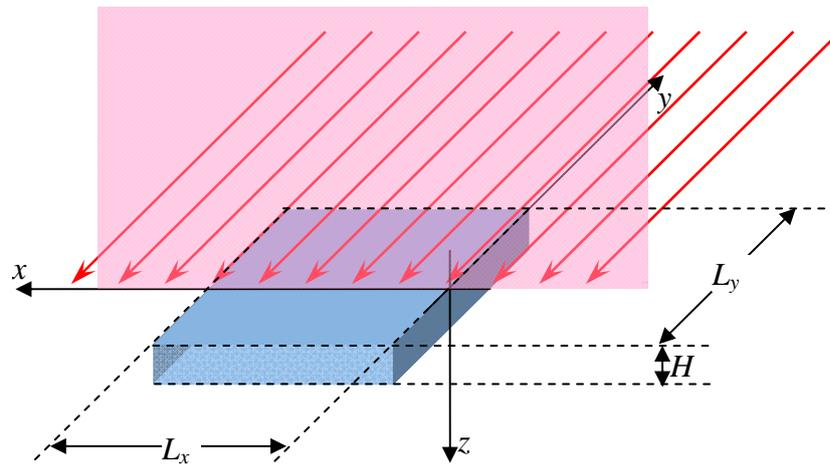
**Рис. 2.** Рассеяние конечным фрагментом красящего слоя (параллельным плоскости  $Oxy$ ). Падающая волна показана красными стрелками; направление падения – в плоскости  $Oxz$ .
