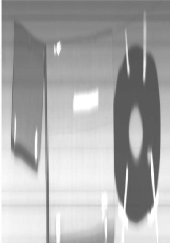
Рис.5. Спектральное изображение – свертка для набора материалов: картон, каменная стена, резиновый круг, скотч
