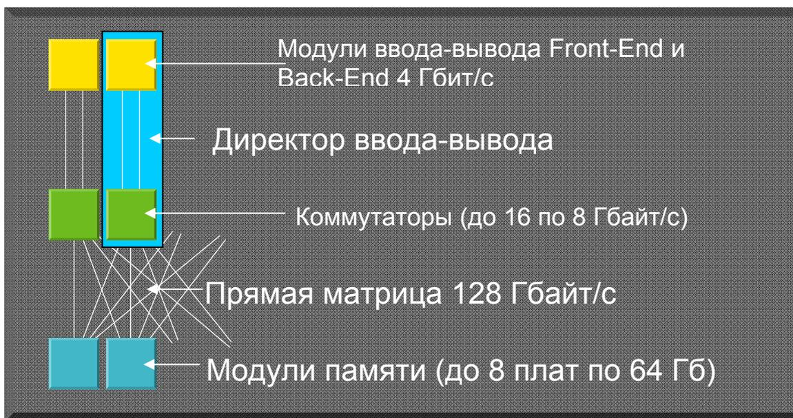
Рис. 2. Архитектура системы хранения EMC Symmetrix DMX4
