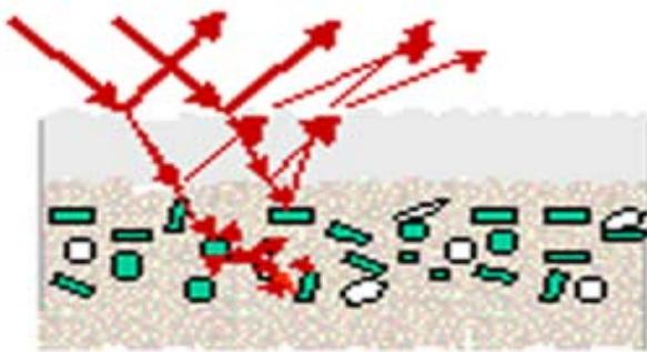
**Рис. 3. Объемное рассеяние света в многослойном лакокрасочном покрытии.**
