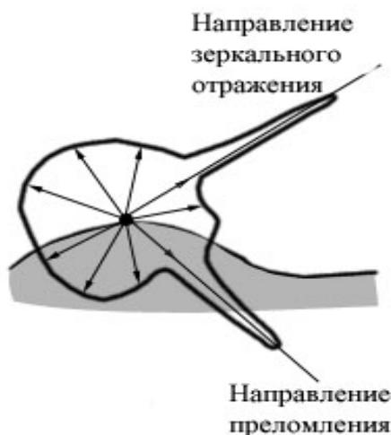
**Рис. 4. График типичной функции рассеяния света (сечение).**
