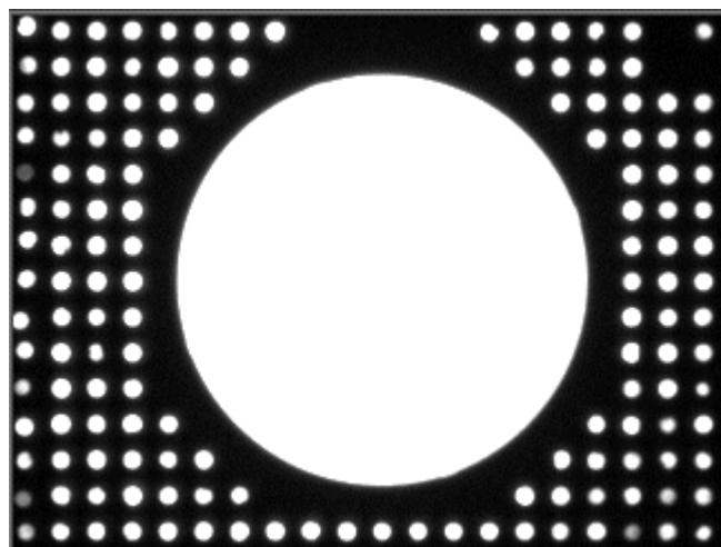
**Рис. 9. Экран с выходами световодов и диффузной пластиной.**
