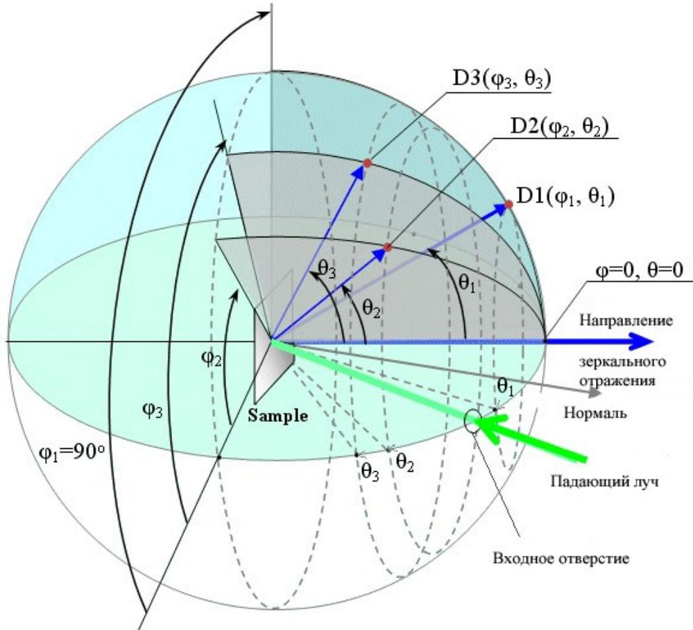
**Рис. 6. Сферическая система координат для направлений отраженного света. Направление отраженного света D1 имеет координаты  $(\phi_1, \theta_1)$ , направление D2 -  $(\phi_2, \theta_2)$  и т.д.**
