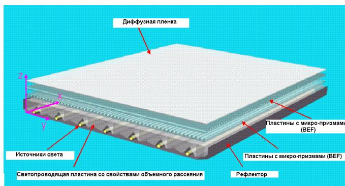
Рис.5-б. Схема системы подсветки жидкокристаллического монитора, построенная на основе светопроводящей пластины с высоким уровнем объемного рассеяния.
