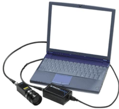
Рис. 10. Аппаратное обеспечение СТЗ на базе ноутбука и устройства DFG 1394
