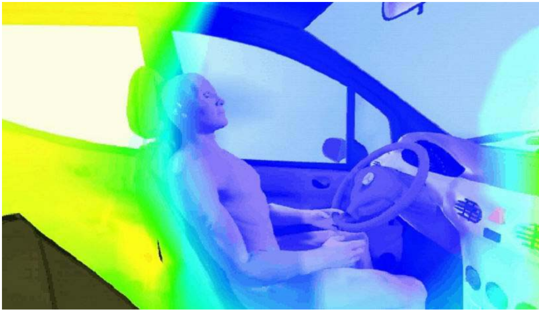
Рис. 2. Распределение температуры воздуха в салоне автомобиля
