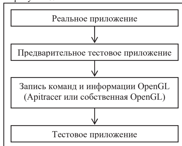
Рис. 6 Схема построения отдельного тестового приложения
