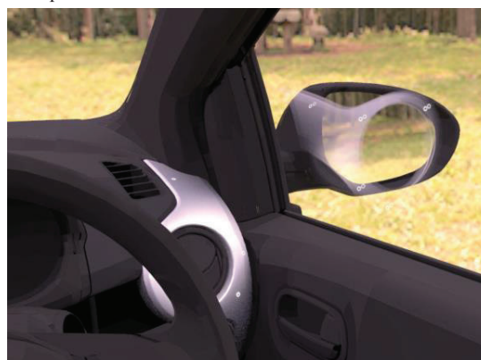
Рис. 3. Визуальная оценка нежелательных отражений в боковом стекле автомобиля.
