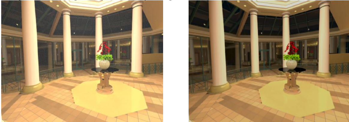
Рис. 6 Результаты моделирования изображения, формируемого фотографическим объективом с блендой и без нее
