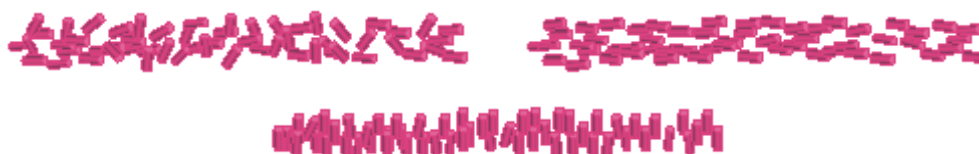
Рис. 3. Ориентации цилиндрических частиц: хаотическая, преимущественно вдоль слоя, преимущественно поперек слоя.
