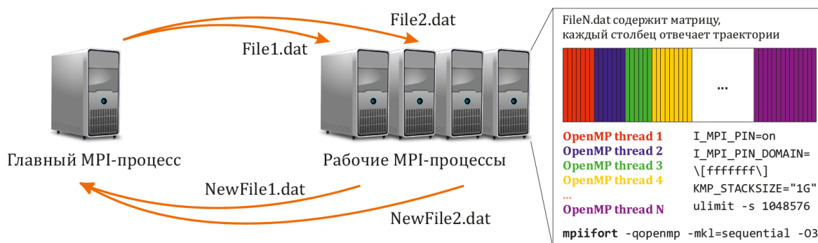
Рис. 2. Схема распараллеливания MPI+OpenMP при построении базы виртуальных траекторий
