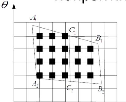
С<sub>1</sub>С<sub>2</sub> – траектория подспутниковой точки А<sub>1</sub>А<sub>2</sub>, В<sub>1</sub>В<sub>2</sub> – траектории боковых точек
