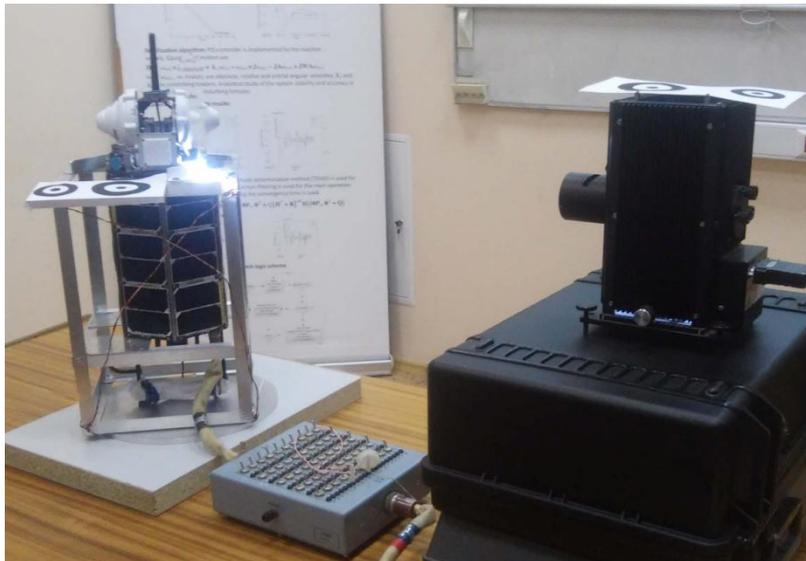
THC-0 №2 в имитаторе магнитного поля
