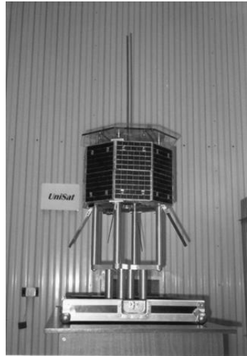
Итальянский UniSat-4, 2004г., пассивная магнитная система ориентации, 12 кг
