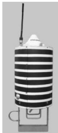
Российский ТНС-0, 2005г., пассивная магнитная система ориентации 4.5 кг (фото РНИИ КП)
