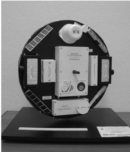
Российский THC-1, активная магнитная система ориен- тации (фото РНИИ КП), 7 кг
