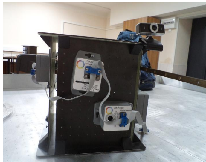
Рисунок 4.2. Макет с отклонённым от положения равновесия нежёстким элементом
