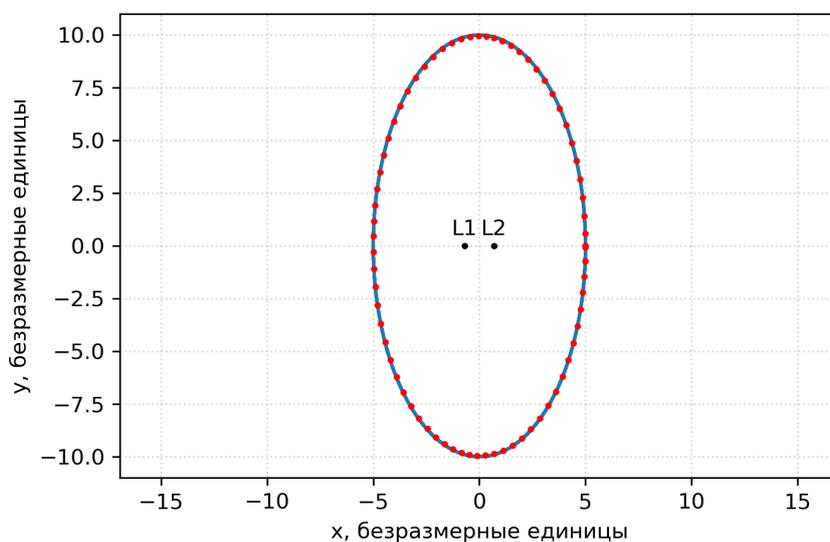
Рис. 4 – Приближенное решение – сплошная синяя линия. Скорректированное методом дифференциальной коррекции решение – красные точки.
