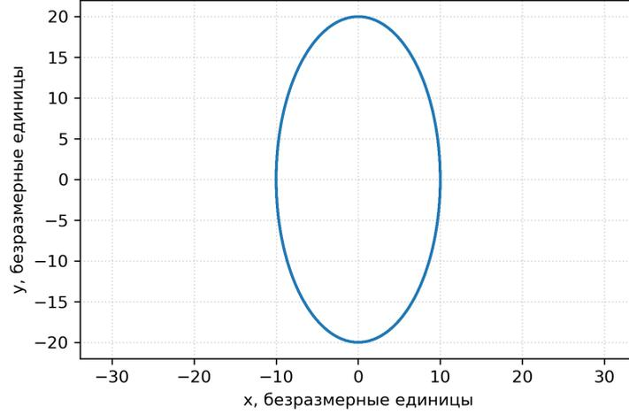
Рис. 3 – Линейный дрейф центра эллипса, изображенный на предыдущем рисунке, устранен выбором начальных условий.
