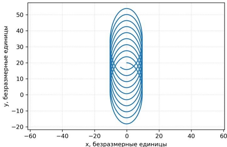
Рис. 2 – Пример квазиспутниковой орбиты с дрейфом центра эллипса.
