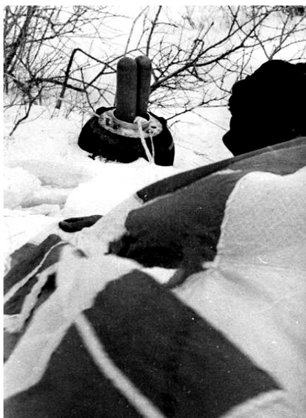
Рис.4. «Луна-20». Контейнер с лунным грунтом.
