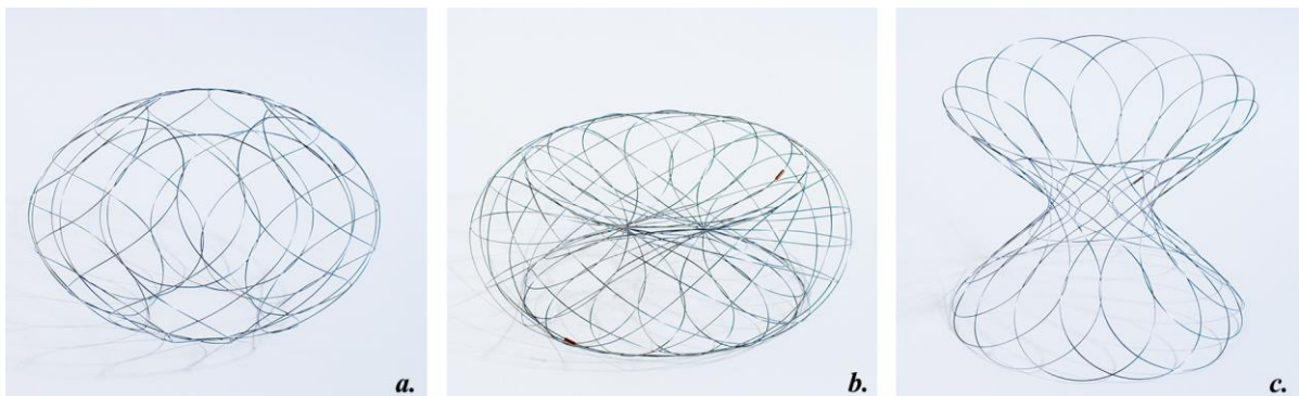
Рис. 3. Поверхности эллиптической (а), параболической (b) и гиперболической (с) гауссовой кривизны, образованные структурами упругих узлов.
