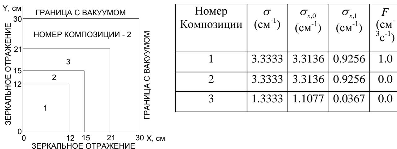
Рис. 13. Железо-водная композиция (Khalil, 1985) в  $x, y$  геометрии.
