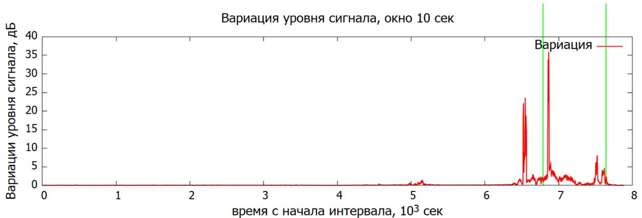
Рис. 5.6. Вариация уровня сигнала с длиной окна 10 сек вдоль траектории сближения ТГК «Прогресс МС-10» и МКС 18.11.2018.
