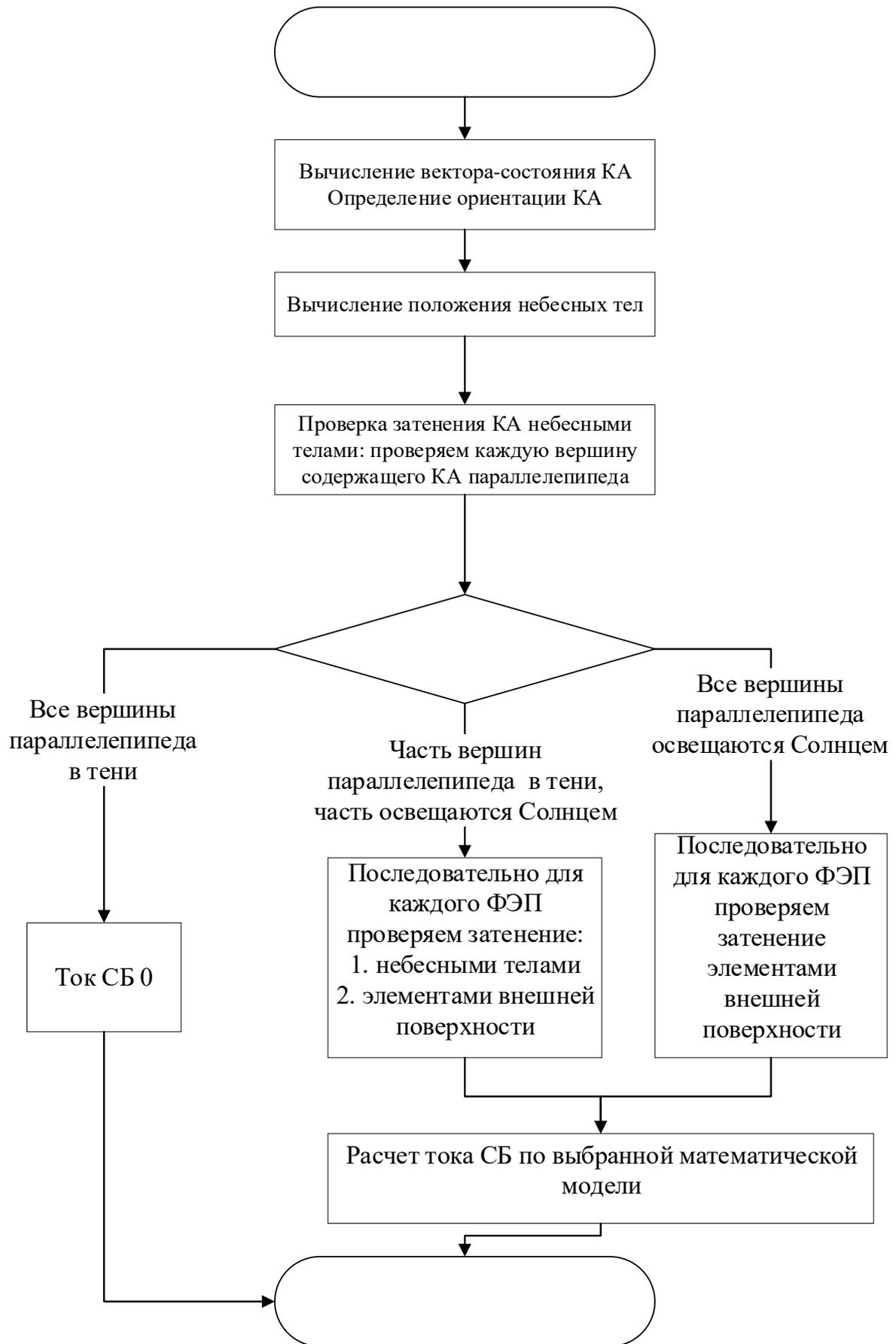
Блок-схема. 3.1. Алгоритм расчета электрического тока СБ КА
