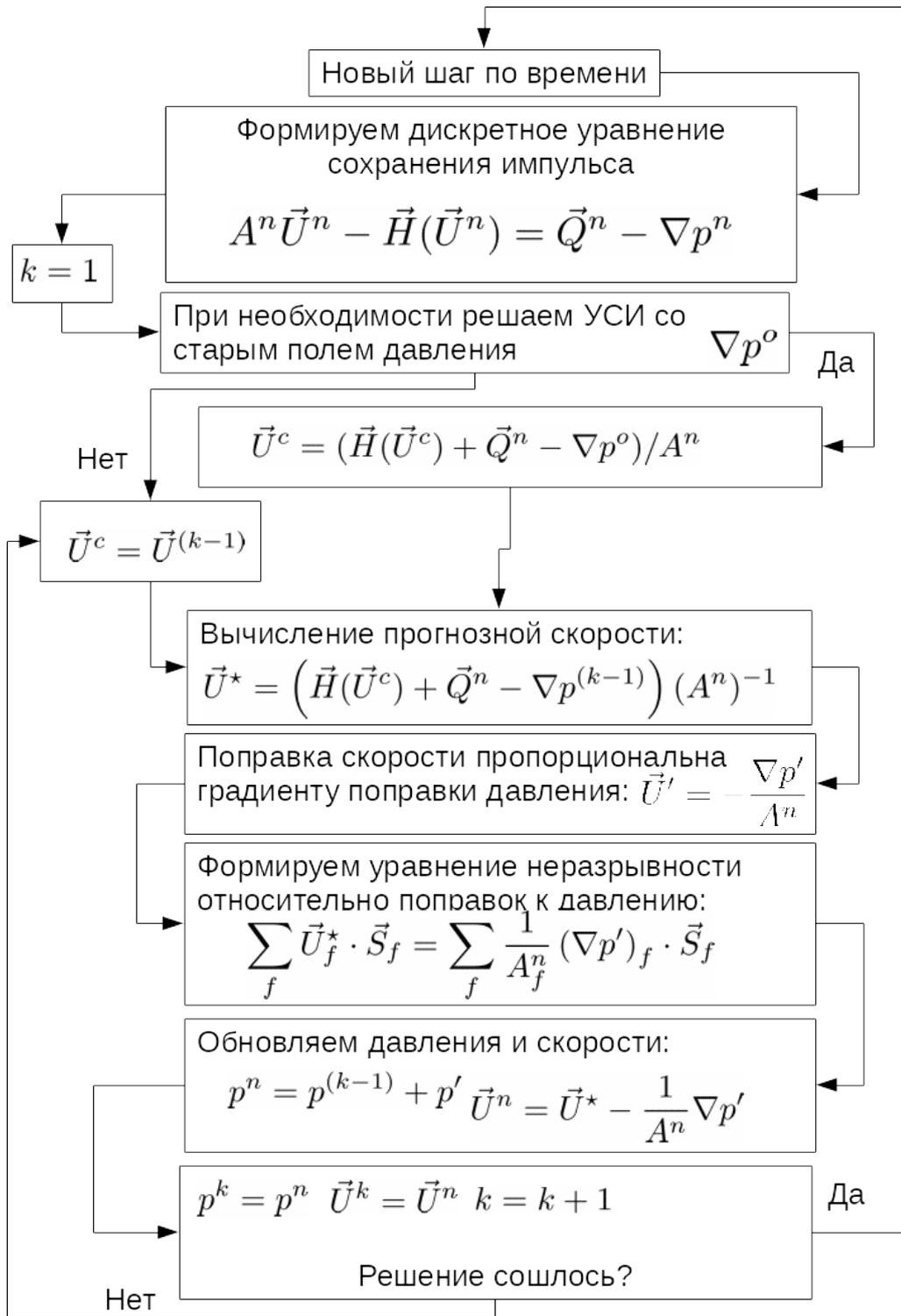
Рис. 1.12. Блок-схема алгоритма связывания скорости и давления PISO
