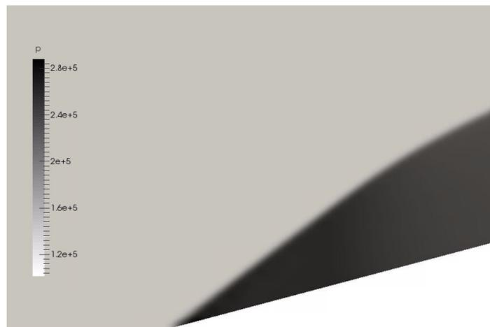
Рис. 3.10. Поле давления при обтекании косоугольного уступа сверхзвуковым потоком
