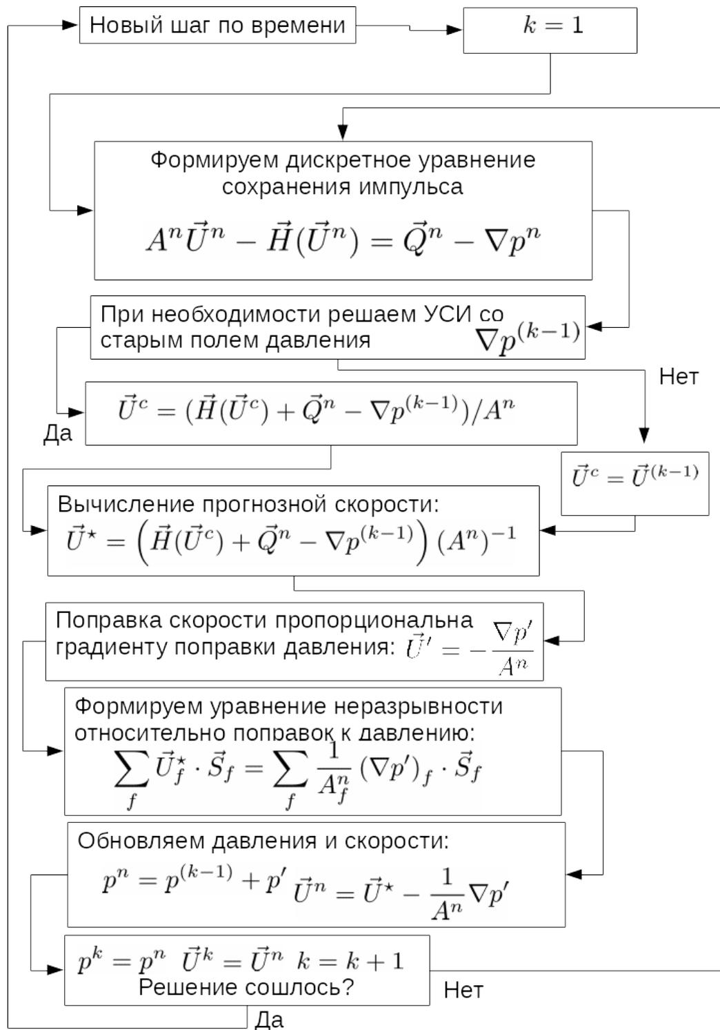
Рис. 1.11. Блок-схема алгоритма связывания скорости и давления SIMPLE
