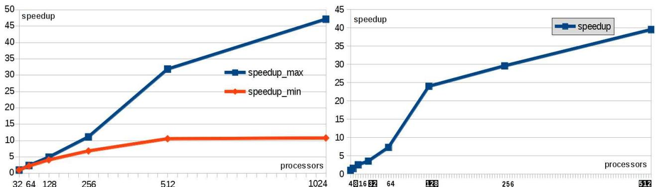
**Рис. 33. Сильное масштабирование параллельного инкрементного алгоритма и параллельного алгоритма геометрической декомпозиции**
