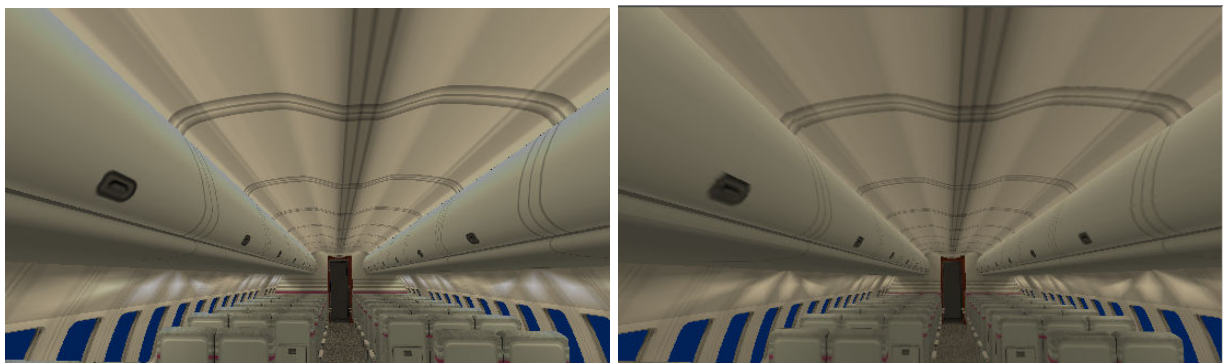
Рис. 11 – Изначальная рассчитанная освещенность салона самолета (слева) и освещенность в VRML формате с упакованными текстурами (справа)
